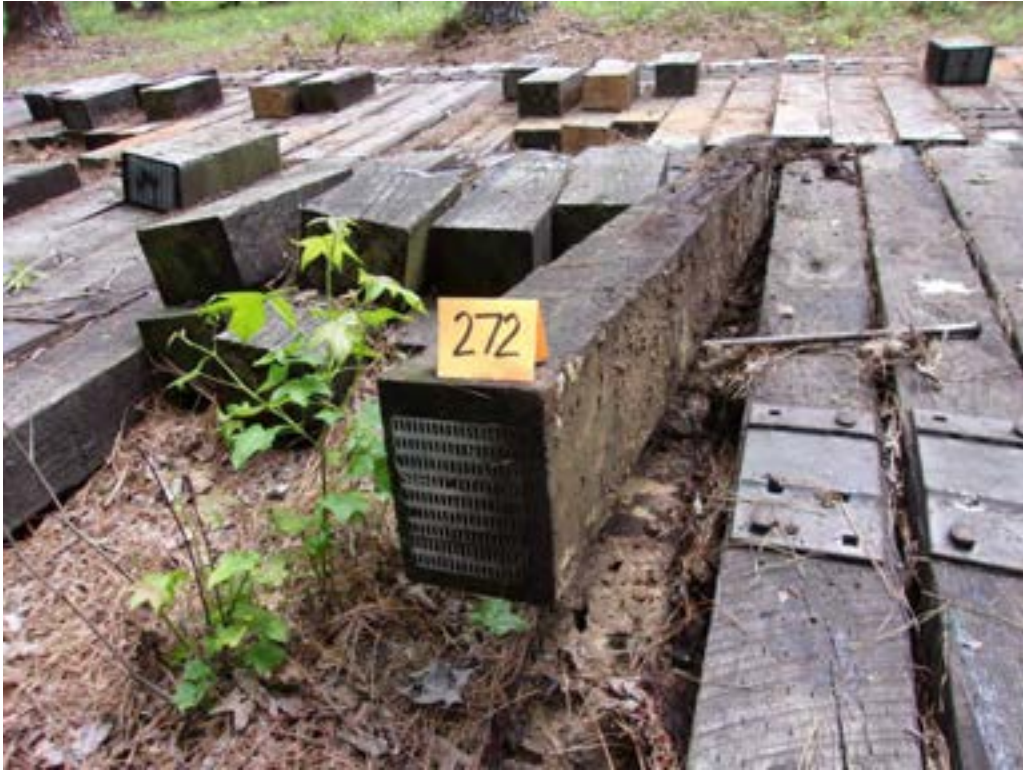
A55 - Tie #272 (Koppers/white oak/P2 creosote).
