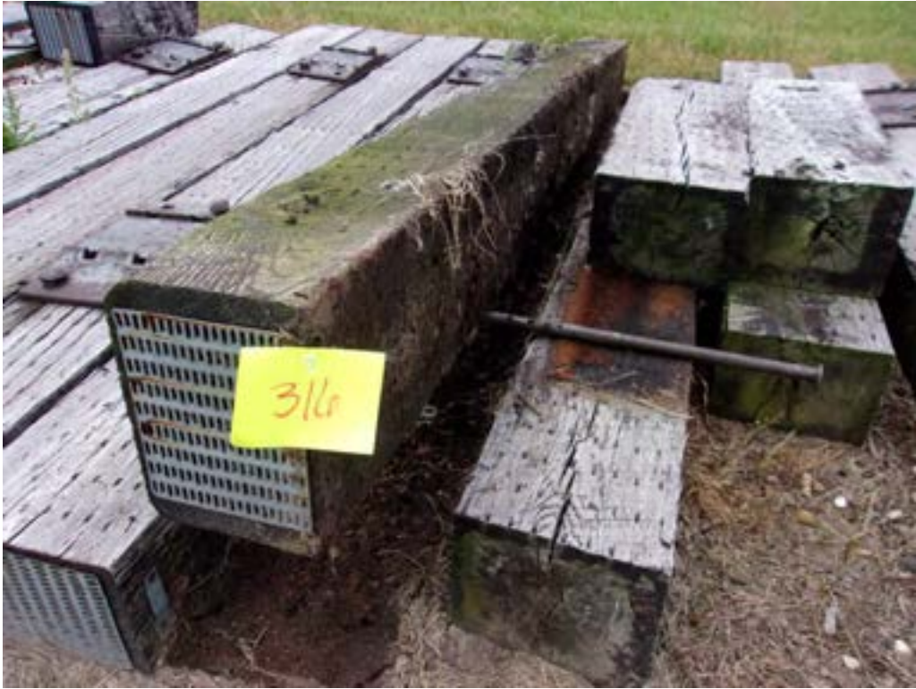
A127 - Tie #316 (Koppers/red oak/P2 creosote).
